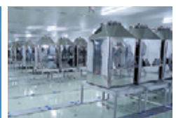
上:床面にあるQRコードを読み取りながら自動搬送される調合容器 左:第3SD棟外観(2019年12月竣工) 下:調合容器を反転するロボットアーム
