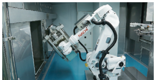
上:床面にあるQRコードを読み取りながら自動搬送される調合容器 左:第3SD棟外観(2019年12月竣工) 下:調合容器を反転するロボットアーム
