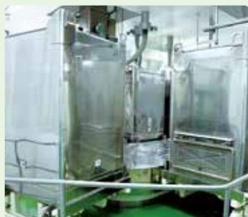
通过津村特有装置,用与汉方传统方法相同的方法进行提取,提取液经过离心分离机过滤后,使用对其成份影响最小的机器进行低温和短时间浓缩。
