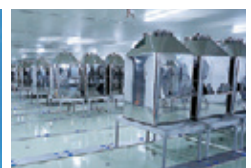
上: 边读取地面上的QR码边自动搬运的调配容器 左: 第三SD车间外观(2019年12月竣工) 下: 将调配容器移向提取装置的机器人手臂
