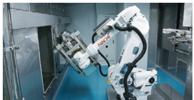
上: 边读取地面上的QR码边自动搬运的调配容器 左: 第三SD车间外观(2019年12月竣工) 下: 将调配容器移向提取装置的机器人手臂
