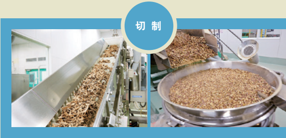
*在上海津村，对原料生药进行从切制到干燥的加工，生产浸膏粉末。在上海生产的浸膏粉末被运到静岡和茨城的两家工厂，进入制粒以后的工序。
