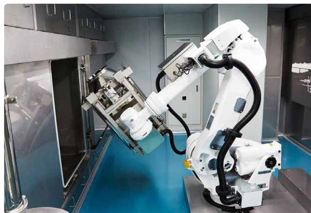
容器を反転させる多軸ロボット
