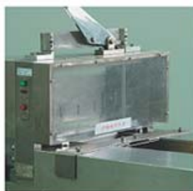
▲切裁機の安全カバーの設置
