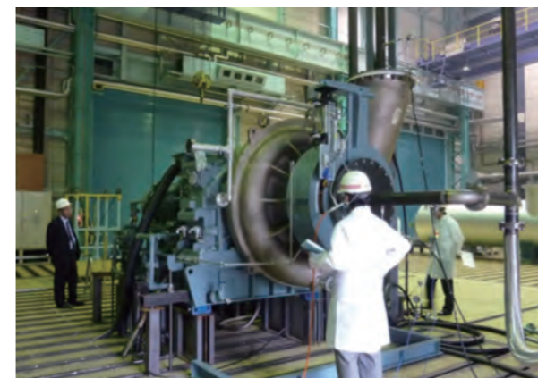
MVR (茨城工場)
